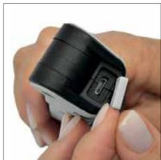
Aufladung über USB-Ladekabel mit Micro-USB-Anschluss
