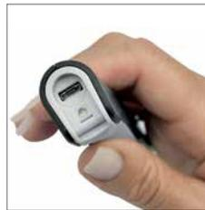
Aufladung über USB-Ladekabel mit Micro-USB-Anschluss
