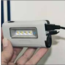
Aufladung über USB-Ladekabel mit Micro-USB-Anschluss
