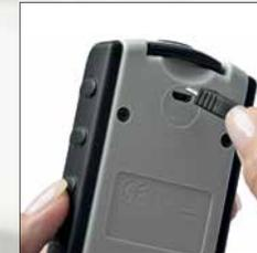
Aufladung über USB-Ladekabel mit Micro-USB-Anschluss
