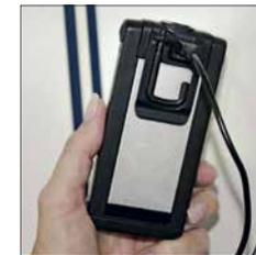
Aufladung über USB-Ladekabel mit Micro-USB-Anschluss
