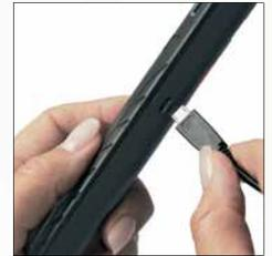
Aufladung über USB-Ladekabel mit Micro-USB-Anschluss
